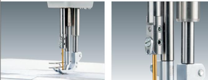
H867-70のサブクラスは、3種類の異なる針システムに合わせてニードルアダプターを標準装備しています。それにより、針棒の高さを機械的に調節する必要がありません。
