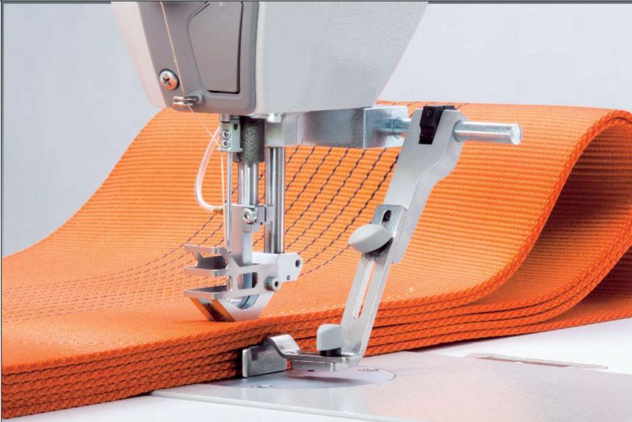
H-TYPE は、幅広い縫い目長さ、強力な材料送り、大きな貫通力により、重量のあるキャリングベルトの縫製に最適な条件を備えています。
