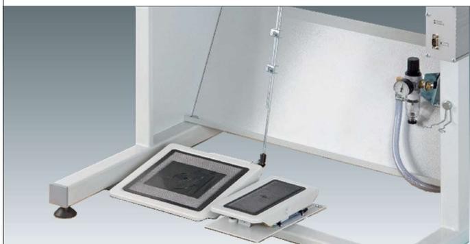
このクラスのために特別に強化されたマシンスタンドは、安定性と振動の補正に関して、最適な動作条件を保証します。追加ペダル (オプション) により、素材取り廻す作業を妨げることなく、返し縫い縫製を行うことができます。
