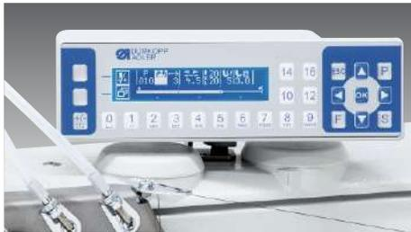
**標準の操作パネル「OP3000」でのプログラム制御** — 縫製プロセスに関するすべてのパラメーターを手入力する以外に、オートマチックモードでは、以前プログラムした設定や複雑なシームプログラムを呼び出すことができます。プログラムされたパラメーターは、すべてプログラムと連動し、分かりやすく構成されています。
