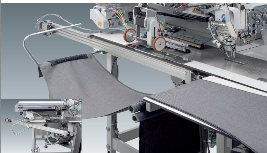
755 B / 756 B - パンツ用スムージング装置 (オプション 0755 591104) - バンドルクランプ との組み合わせ (オプション 0755 591154) またはバンドルトrolleyを使用して、縫製後の バンドル内のパンツ製品をスムーズに重ねる ことができます。 ロールオフ装置との組み合わせでのみ使用可能。 (オプション 0755 590954)
