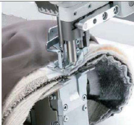
**自動厚さ検知センサー**で素材厚さを自動感知しプログラムすることが可能です。
