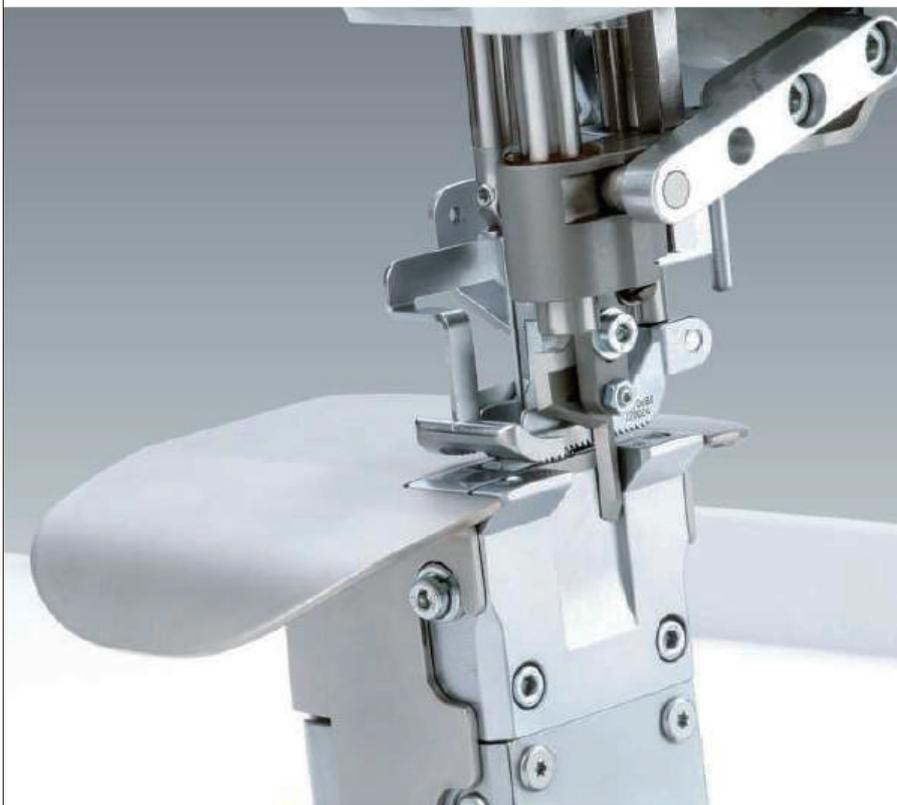
**680のエアー式エッジカッター**は、機能ボタンを使用して簡単にon/offの切り替えが可能です。縫いピッチ6mmまたは9mmの場合に、6.4mm、8mm、10mmのカット幅を選定できます。
